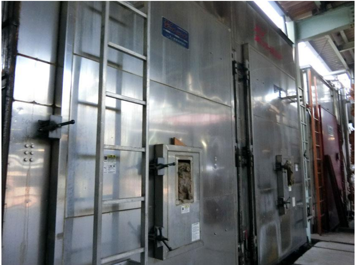
この巨大な乾燥窯で含水率を 15% まで落としていきます
