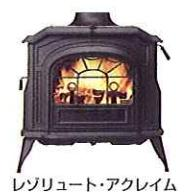
薪の燃焼（一次燃焼）と、煙の燃焼（二次燃焼）を異なる2つの燃焼室で行う燃焼方式のひとつ。アンコール・エヴァーバーンの心臓部である二次燃焼室は、耐火セラミックの隔壁と耐火性、蓄熱性、耐久性に優れ、自然流体を駆使しています。その際、熾き火の上を未燃焼ガスが通り、二次燃焼室入口にあるリフラクトリーシューから出る空気と混ざります。熱くなったこの未燃焼ガスが二次燃焼室の中をファウンテン状（噴水状）に流れ、再燃焼します。
