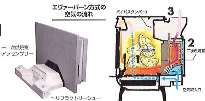
セラミックファイバー製の二次燃焼室内に耐火セラミック製のリフラクトリーシューが設置され、二次燃焼室で未燃焼ガスを燃やします。
